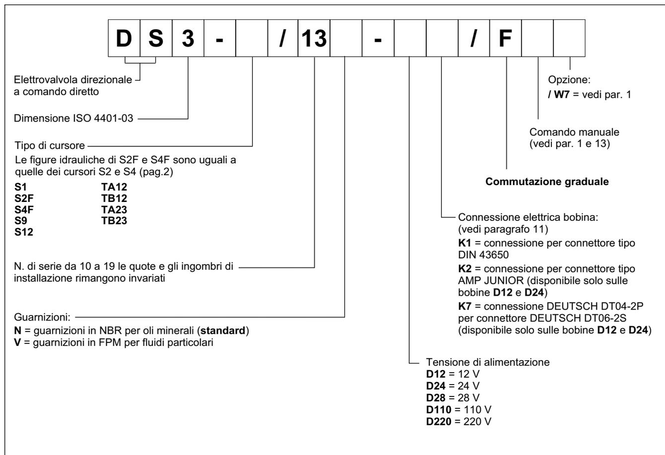
Questa versione consente di addolcire la partenza e l'arresto degli attuatori idraulici mediante un movimento rallentato del cursore.
