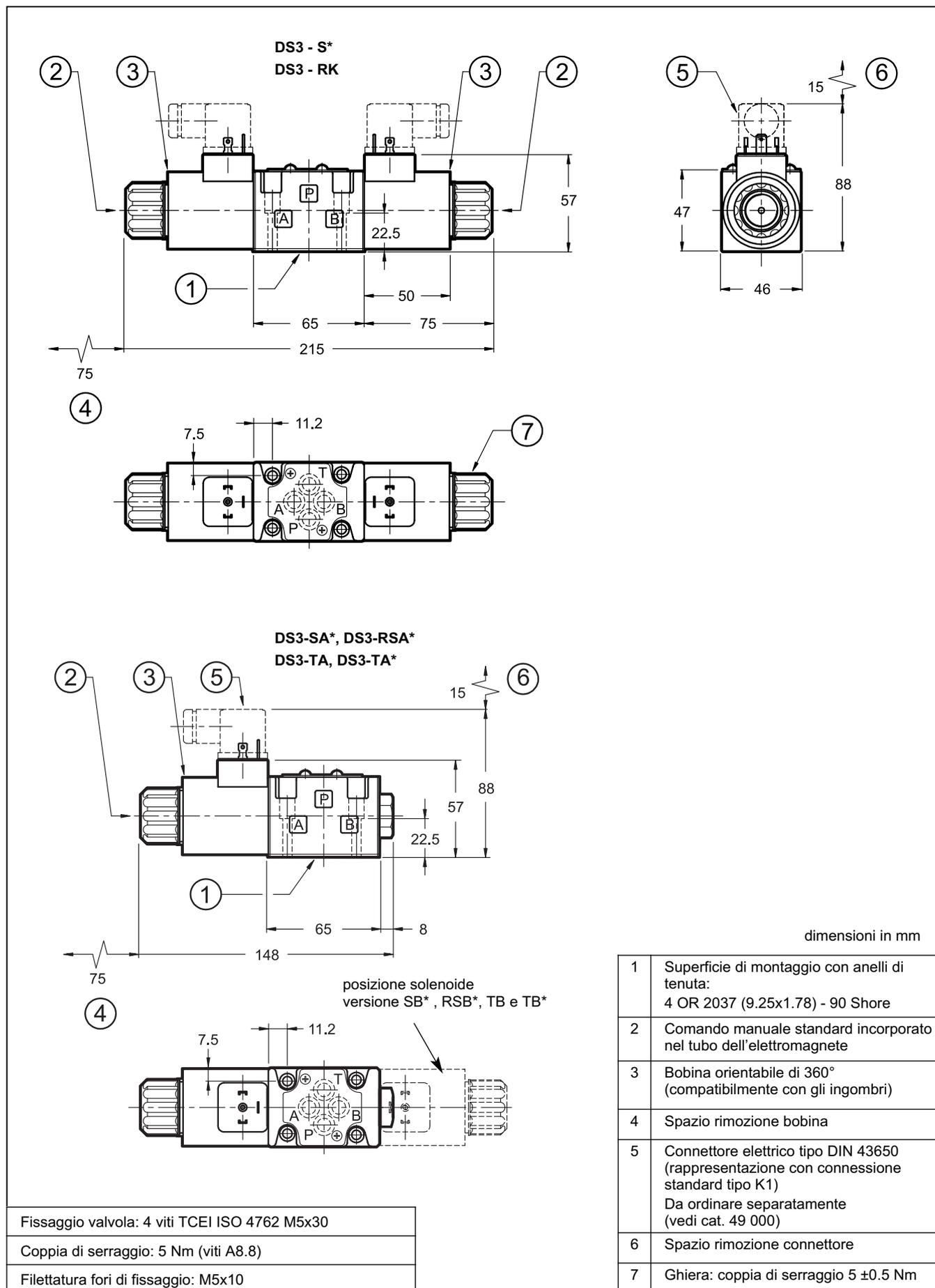
9 - DIMENSIONI DI INGOMBRO E DI INSTALLAZIONE ELETTROVALVOLA IN CA
