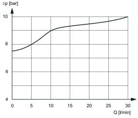
Perdite di carico con flusso  $A \to T$  attraverso il compensatore.
